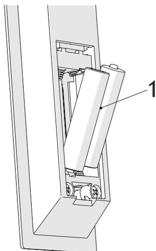
Ci sono due batterie nel telecomando. Tirare le batterie premendo poli + e rimuovere dallo slot della batteria (Fig. 22).
